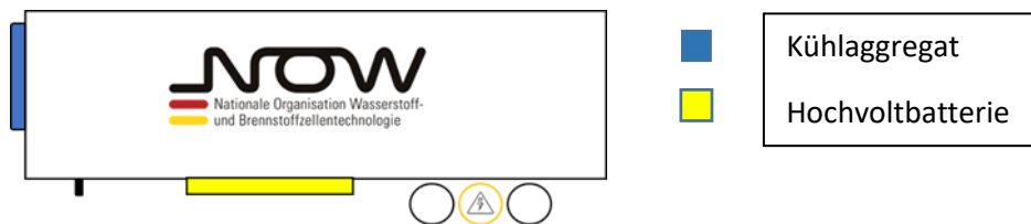
Abbildung 33: Integration des Konzeptes "Rekuperationsachse + Kühlung" an einem Auflieger (Quelle: eigene Darstellung)
