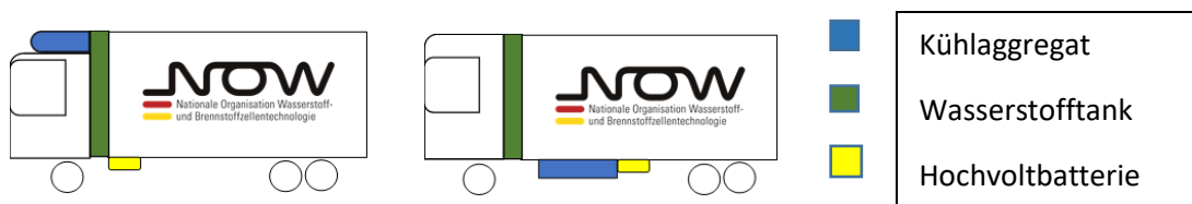
Abbildung 37: Komponentenintegration bei emissionsfreien Motorwagen
