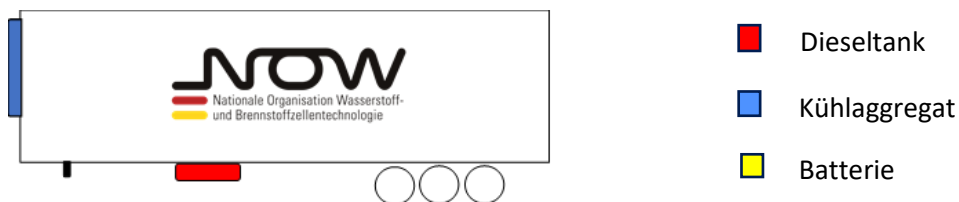
Abbildung 5: Überwiegende Position aktueller Kühlaggregate am Auflieger eines Sattelzuges, Quelle: Eigene Darstellung
